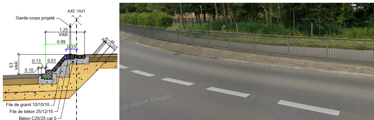
Figure 4: Coupe type et photo soutènement rehaussement chemin mixte zone Technopolis
