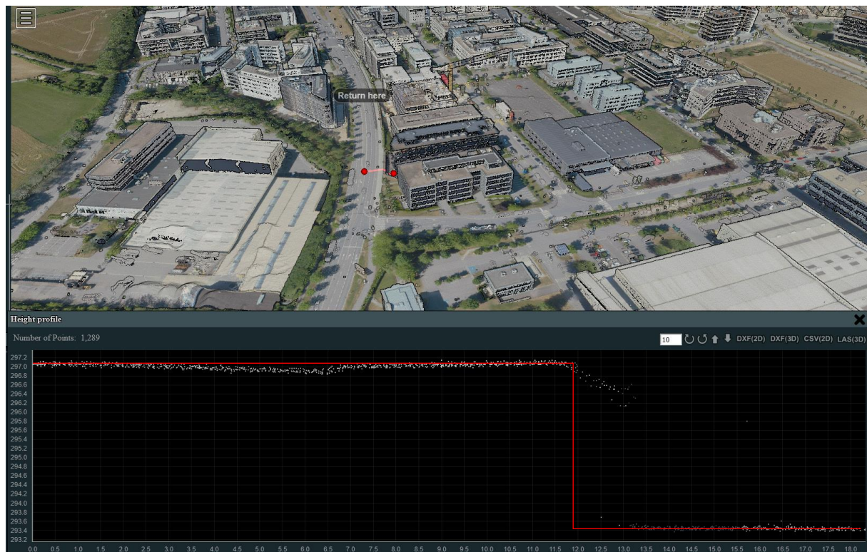
Figure 21: Coupe Lidar - ouvrage de soutènement existant
